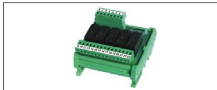
Modulo 5-relé esterno per aumentare la portata dei contatti di scambio a 2A/115Vac. External 5-relay module to increase the capacity of SPDT contacts to 2A/115Vac.
